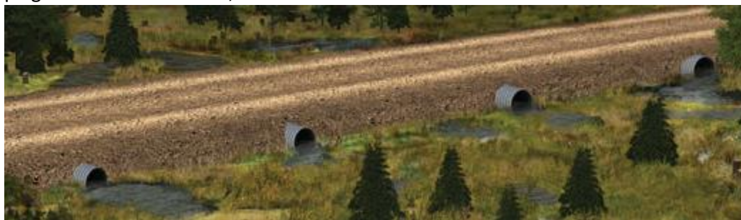
Joonis 33. Truupide kasutamine muutliku veerežiimiga märgaladele teede ehitamisel (Partington jt 2016).
